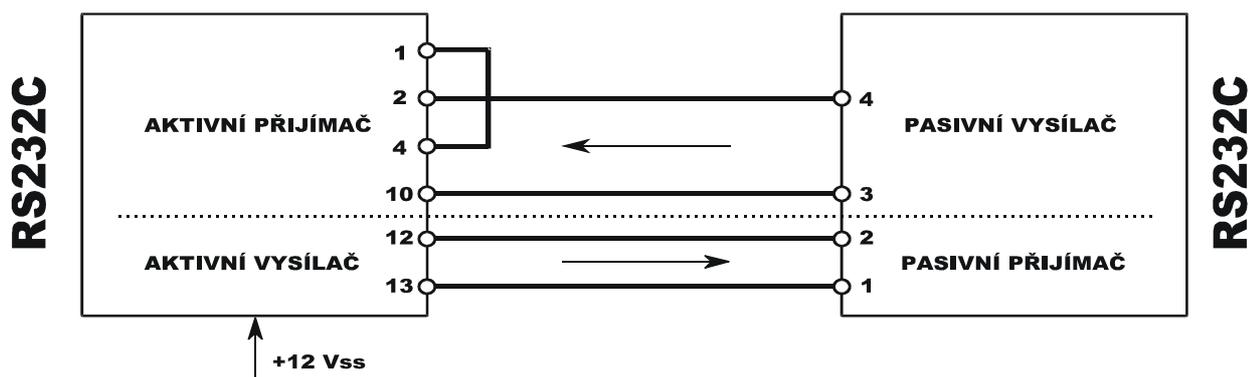
Blokové schéma zapojení proudové smyčky kdy vysílače obou převodníků jsou vždy aktivní a přijímače pasivní. Oba převodníky vyžadují externí napájení.
