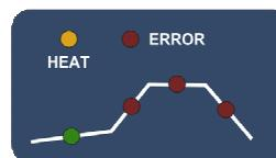
Při běhu programu zobrazuje regulátor měřenou teplotu a na zobrazení průběhu programu svítí LED na pozici právě prováděného úseku programu. Podle probíhajícího úseku programu se dále nižším jasem (po dobu jedné sekundy) zobrazuje:
